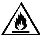
Das Gerät ist mit dem leicht entzündlichen Kältemittel R32 befüllt. Ein unsachgemäßer Umgang mit diesem Gas kann zu schweren Schäden an Personen und Materialien führen. Weitere Einzelheiten zu diesem Kältemittel finden Sie am Anfang dieser Anleitung.
