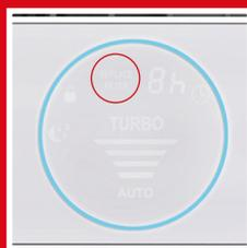
LED-Anzeige auf dem Display für Filterwechsel.
